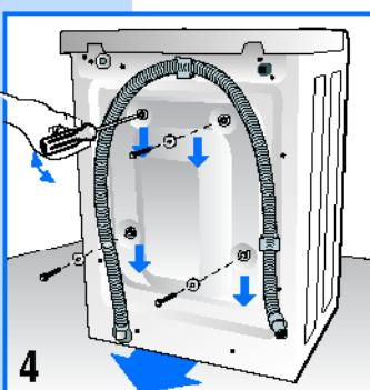
Для транспортировки прибора его качающийся узел блокирован 4 распорками с болтами. Прежде чем подключить машину, при помощи гаечного ключа следует вынуть транспортировочные болты.
