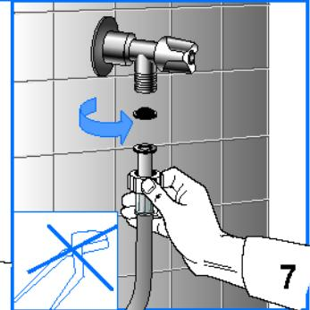
**Прим.** В электронных стиральных машинах, оборудованных двойным электроклапаном (горячей и холодной воды) соедините красную трубку с краном горячей воды, а другую трубку - с краном холодной. Если кран горячей воды использовать нельзя, обе трубы должны быть подсоединенены к крану холодной воды при помощи специального прилагаемого патрубка (смоги рис. 8).
