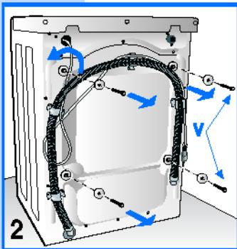
Для транспортировки прибора его качающийся узел блокирован 4 пластмассовыми распорками с болтами. Прежде чем подключить машину, следует вынуть распорки и транспортировочные болты и сохранить их на случай перезда.
