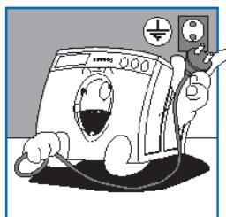
**Стиральная машина должна быть подключена к соответствующим правилам безопасности электрической розетке с заземлением.**
