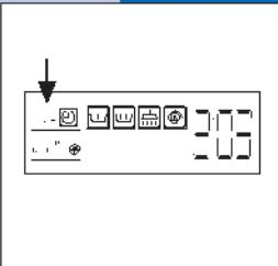
Машина располагает функцией, позволяющей отложить процесс стирки максимум на 16 часов. При каждом нажатии кнопки (I) на дисплее появляется час от 1 до 16, соответствующий времени ожидания начала цикла. После нажатия кнопки (L) стиральная машина ждет введенное в программу количество часов задержки, а затем автоматически начинает цикл стирки.
